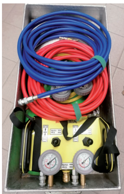
Hebekissen, Aggregat und Schläuche
