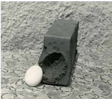
Hageleinschlag in einem noch weichen Drainageauslauf. Größe des Einschlages verglichen an einem Ei.
